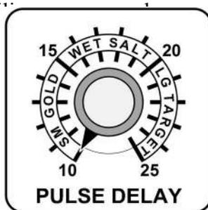
El retraso del pulso afecta el punto de balance de tierra, así que en el momento en el que se cambia el retraso el balance de tierra también debería comprobarse y re-ajustarse. Los retrasos de pulso más altos necesitan una configuración de balance de tierra.
