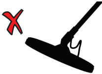
Ángulo incorrecto de la bobina de búsqueda
