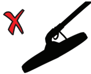
Ángulo incorrecto de la bobina de búsqueda
