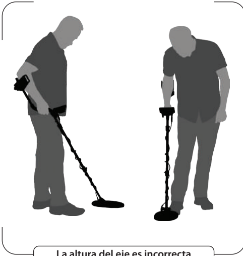
La altura del eje es incorrecta
