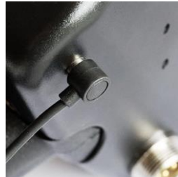
Cable cargador magnético conectado al enchufe del detector
